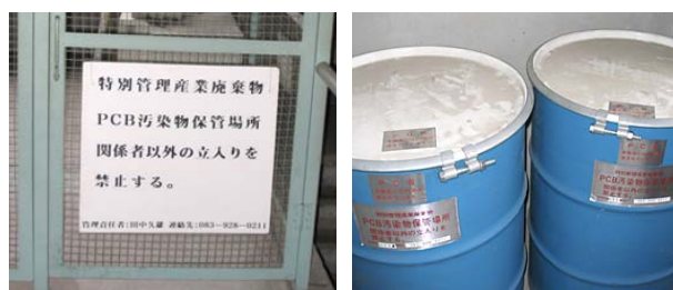
PCB 含有廃棄物の適正保管
